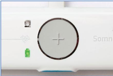
Lorsque le boîtier d'enregistrement est en charge, la LED batterie clignote en vert. Une fois le boîtier chargé, la LED cesse de clignoter et reste verte.
