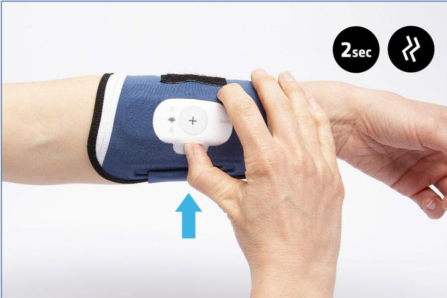
Pour allumer le dispositif, maintenir le bouton ON/OFF enfoncé pendant 2 secondes. Il va émettre deux courtes vibrations et automatiquement afficher l'état de fonctionnement du dispositif pendant 10 secondes.
