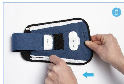
Faire glisser les extrémités du boîtier d'enregistrement dans les encoches de fixation. Une fois le dispositif en place, refermer le brassard à l'aide des fermetures éclair et fixer avec la bande Velcro centrale.
