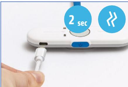
Brancher le câble USB au dispositif puis à l'ordinateur. Le dispositif va émettre deux courtes vibrations et automatiquement afficher l'état de fonctionnement du dispositif.
