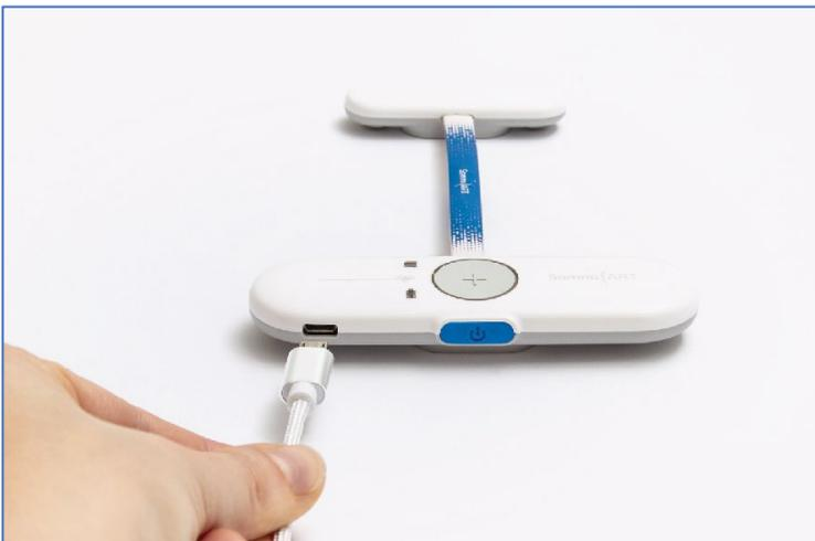
Le boîtier d'enregistrement se recharge en le connectant au port USB d'un ordinateur.
