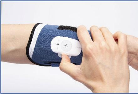
En fonctionnement **Manuel**, l'enregistrement peut être arrêté en appuyant plus de 5 secondes sur le bouton ON/OFF.
