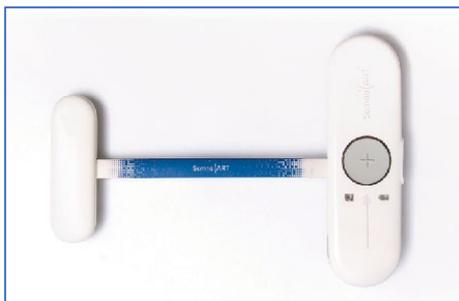
Il permet d'enregistrer le rythme cardiaque en battements par minute (BPM) à une fréquence de 1 Hz. Les mouvements sont enregistrés sur les trois axes et cumulés à la seconde.
